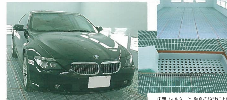
床面は全面グレーチング標準仕様のため、空気が一定でスムーズに流れ、理想的な気流を実現。
