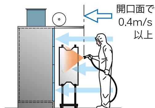
囲い式フードが塗料ミストの飛散を防ぎます。
