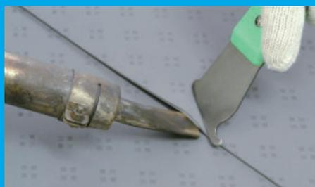
溶着作業時の押さえとしても使用可能。先端部にはR加工、サビないステンレス製を採用。
