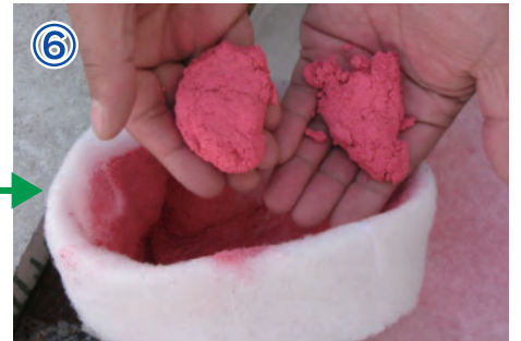
⑥ フィルターの中は乾燥すると完全に固化、再溶解しません。
