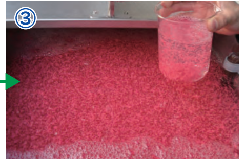
③ 投入後約2分で分離・凝集の処理反応がまります。
