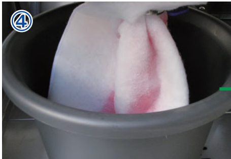
④ 攪拌槽の柱を開けてフィルターに処理水を流し込みます。
