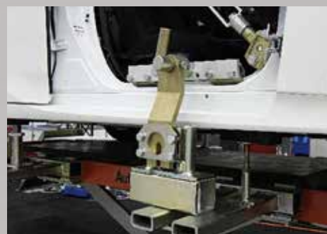
▲ ロッカーパネル上部 (溶接部) を固定
